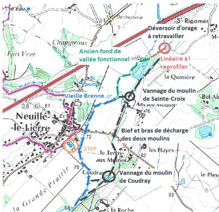
Présentation du système hydraulique de Sainte-Croix et localisation de la future rivière de contournement.
